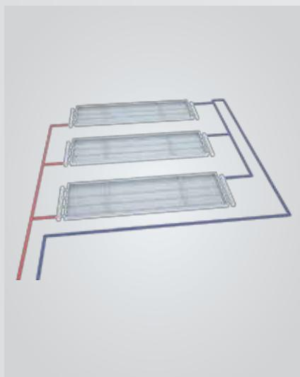
**Fig. 1** : Conduite selon le système Tichelmann
