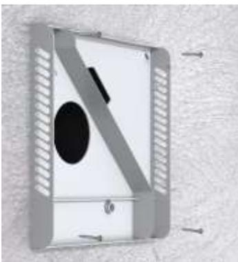
5. Enclenchez l'obturateur extérieur coque supérieure avec toutes les quatre liaisons d'encliquetage de façon étanche sur la coque inférieure. Fixez l'obturateur extérieur coque supérieure avec deux vis respectivement du kit de montage fourni à l'obturatrice extérieure coque inférieure.
