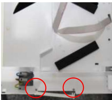
5. Passez le câble plat à travers le passage de cadre de la coque inférieure et le support d'élément de commande. Reconstituez le raccord enfichable entre le câble plat et la feuille de commande.
