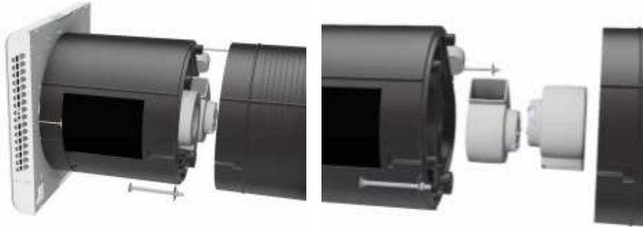
5. Les ventilateurs identiques peuvent être sortis du boîtier en EPP après avoir débranchés de la platine de commande avec les câbles de raccordement tracés en même temps. A cette occasion, veillez à ne pas endommager les bandes d'étanchéité dans la zone des ventilateurs.
