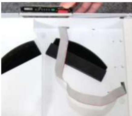
6. Posez le câble plat dans les points de fixation prévus, tout en respectant d'un recouvrement doux dans la zone des déviations 90°. Enclenchez ensuite la feuille de commande dans la position adéquate sur le support d'élément de commande.
