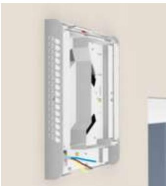
7. Alignez l'appareil en position vertical des grilles de passage d'air latérales de l'obturateur intérieur coque inférieure à plomb et transférez la mesure du trou de perçage au mur (en liaison avec kit de montage brut rond ou bien sur le boîtier en EPP des kit de montage brut carré), et percez un trou pour la cheville du kit de montage ou pour une autre cheville appropriée pour le support.
